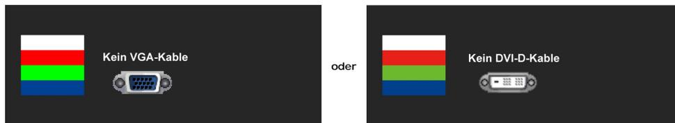
4. Diese Anzeige erscheint auch im Normalbetrieb, wenn das Videokabel getrennt oder beschädigt wird.
