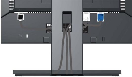
Verwenden Sie nach dem Anbringen aller erforderlichen Kabel an Ihren Monitor und den Computer (siehe [Anschließen Ihres Monitors](#) für Hinweise über das Anschließen der Kabel) den Kabelhalter, um sämtliche Kabel wie oben abgebildet sauber zu verlegen.
